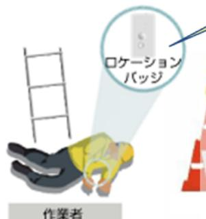
転落・転倒などの事故を端末内の加速度センサが検知し、自動的に現場管理者にアラームを通知
